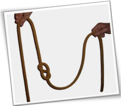
1) Je réalise le nœud de 8 à bonne distance du bout de corde
